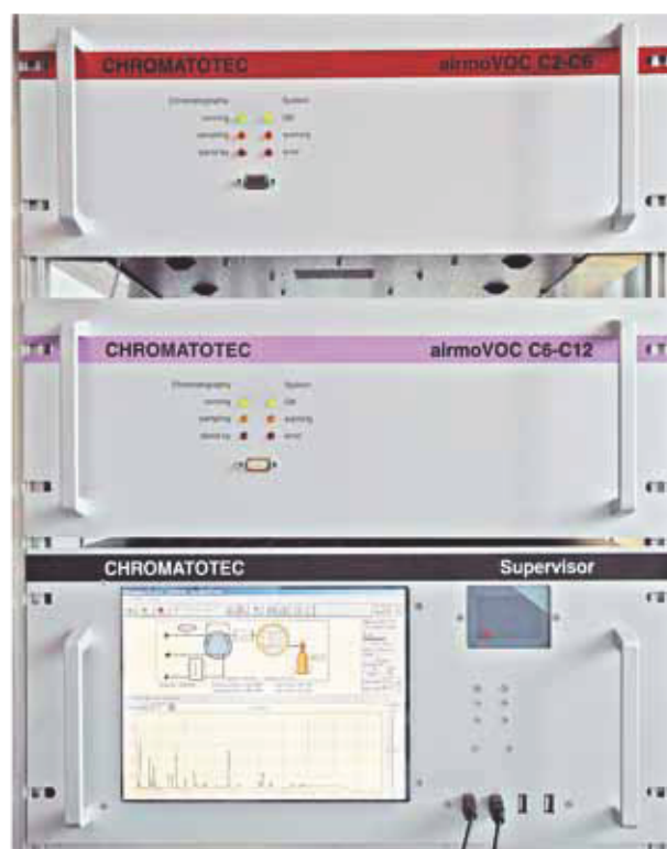
Abb. 6: Messplatz zur Erfassung von Benzolimmissionen.
