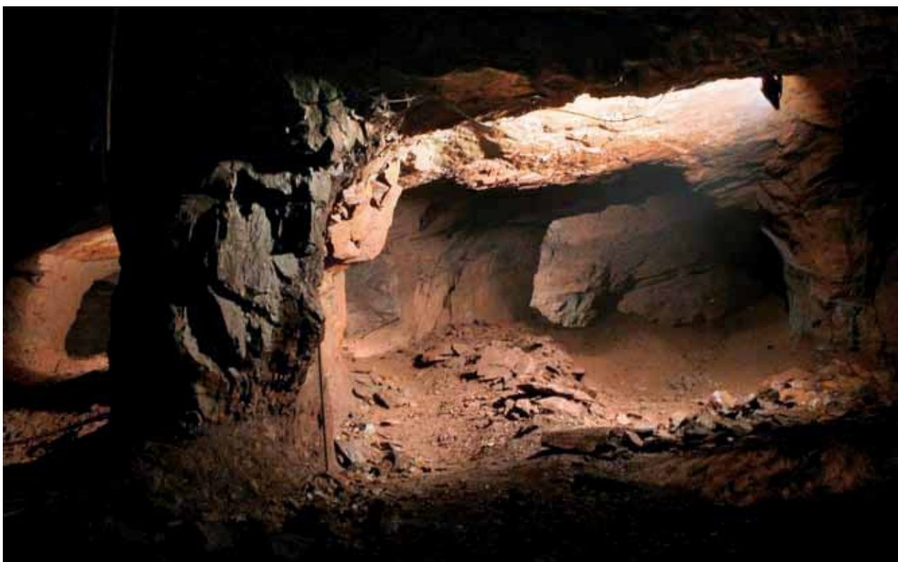
Abb. 3: Grube „Fortuna“ bei Solms-Oberbiel, ehemaliger Schrapperabbau über der 150m-Sohle, Örterbau ohne Versatz (Foto Förderverein Besucher-Bergwerk Fortuna e. V., Wetzlar).
