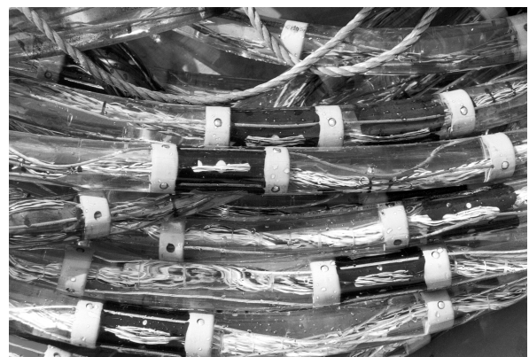
Abb. 3. Hydrophone (schwarz) sind in der flüssigkeitsgefüllten Schleppleine eingebettet.
