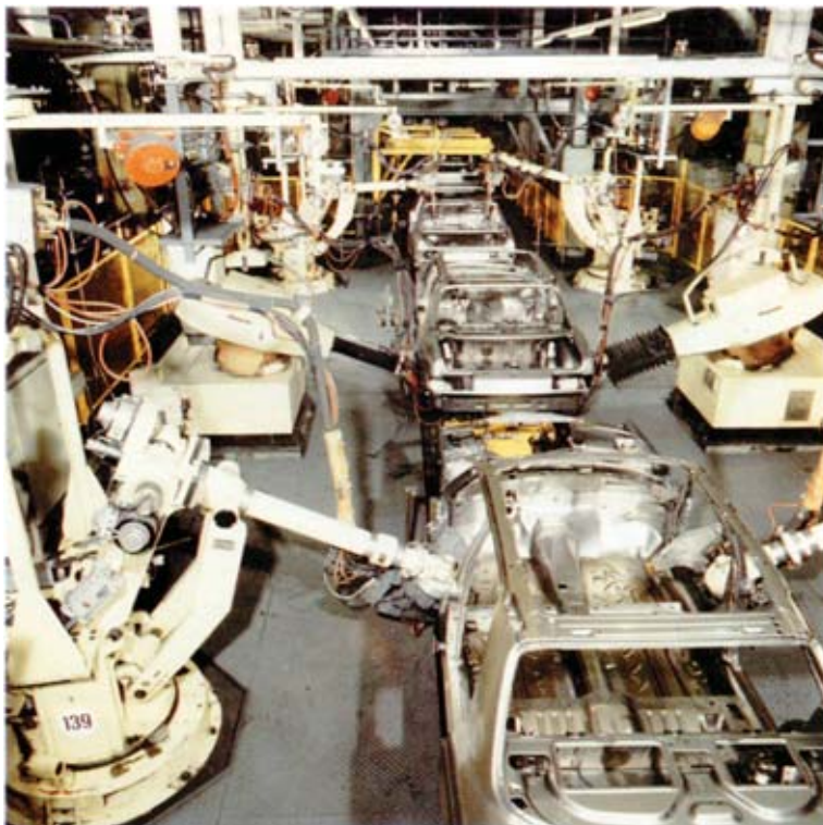
Vom Fließbandarbeiter zum Roboter - wurde 1955 das Goggomobil noch von Hand montiert, so werden heute in der Autoindustrie vorwiegend Roboter eingesetzt
