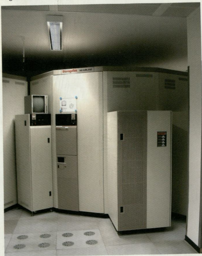
Der Speicherturm für Magnetbänder. Diese große Maschine sortiert mit Hilfe eines darin befindlichen Roboterarmes Magnetbänder in die dafür vorgesehenen Fächer.
