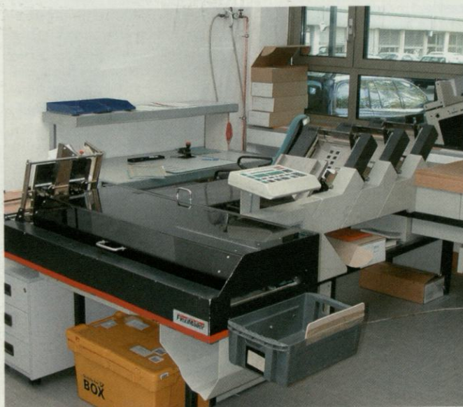
Die moderne Kuvertiermaschine muss rund 80.000 Briefsendungen pro Monat bewältigen.
