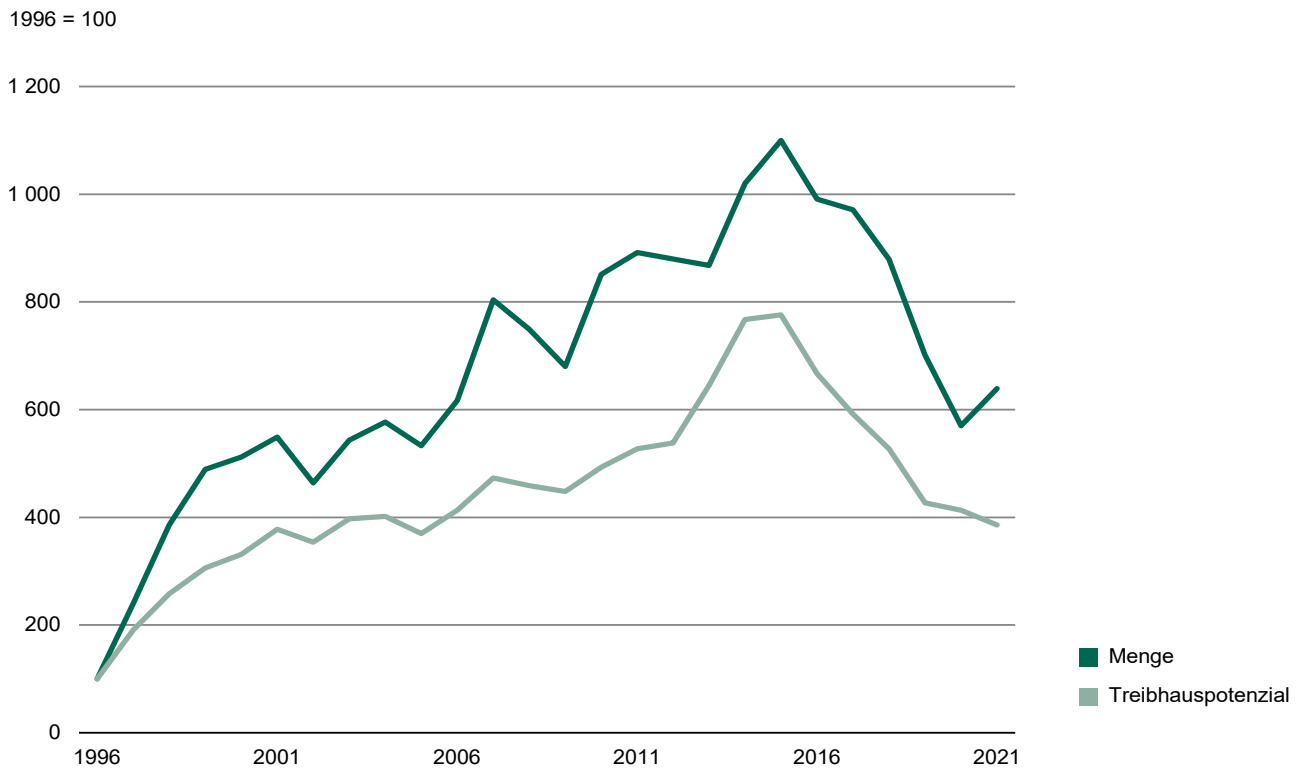
Abb. 9 Menge und Treibhauspotenzial der verwendeten Fluorkohlenwasserstoffe unter Berücksichtigung der Zuordnung der in Blends enthaltenen Stoffe 1996 bis 2021 1)
