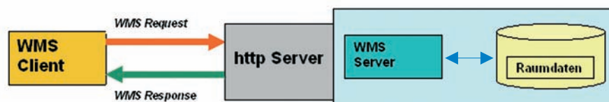
Abb. 4: Schematische Darstellung der Funktionsweise eines WMS
