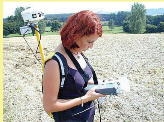
Das Feld wird umlaufen und die Probemessungen ergeben einen Flächenwert, der in einen PC übertragen wird.
