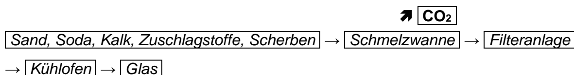
Abbildung 11 Schematische Darstellung der CO 2 -Freisetzung bei der Glasherstellung
