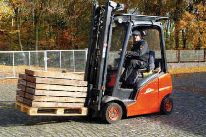
Abb. 2: Transport einer Bohrkernpalette mit dem gasbetriebenen Gabelstapler.
