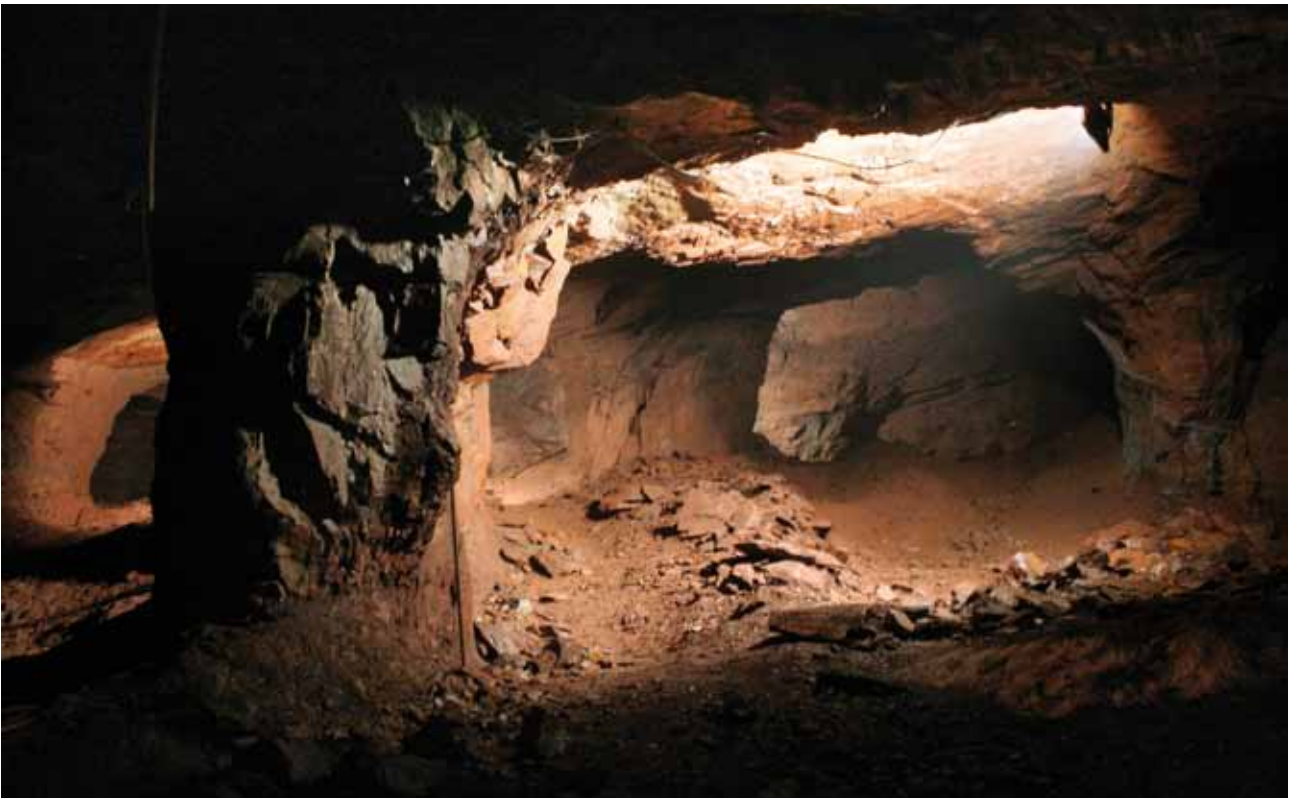
Abb. 3: Grube „Fortuna“ bei Solms-Oberbiel, ehemaliger Schrapperabbau über der 150m-Sohle, Örterbau ohne Versatz (Foto Förderverein Besucher-Bergwerk Fortuna e. V., Wetzlar).
