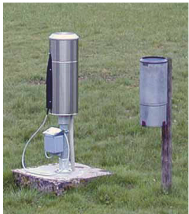
Abb. 1: Ombrometer (links) und Niederschlagsmesser.
