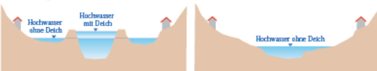
Abb. 8: Wasserrückhalt in der Aue.
