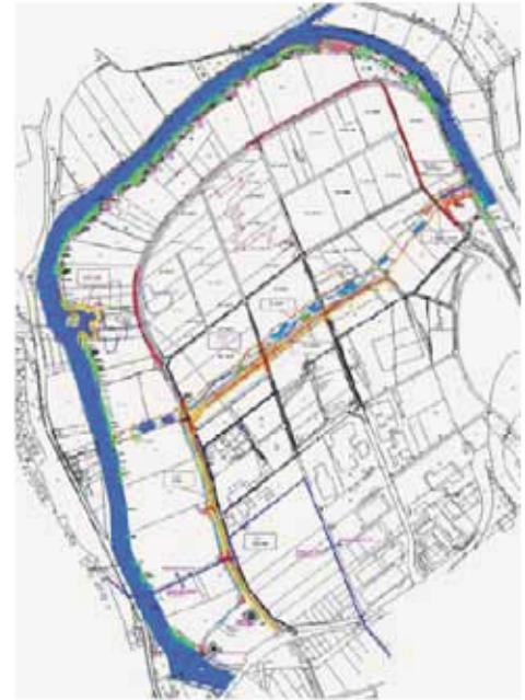
Abb. 9: Rückverlegung der Lahndeiche bei Marburg-Wehrda.
