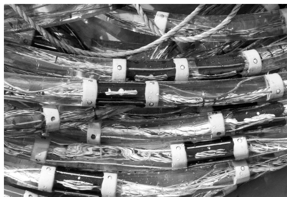
Abb. 3. Hydrophone (schwarz) sind in der flüssigkeitsgefüllten Schleppleine eingebettet.
