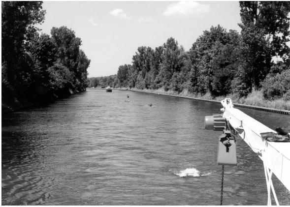
Abb. 4. Hydroseismik im Einsatz: Bei der Schussabgabe der Luftdruckkanone (im Vordergrund) entsteht eine kleine Fontäne. Die Boje im Hintergrund markiert das Ende einer der beiden Schleppleinen.
