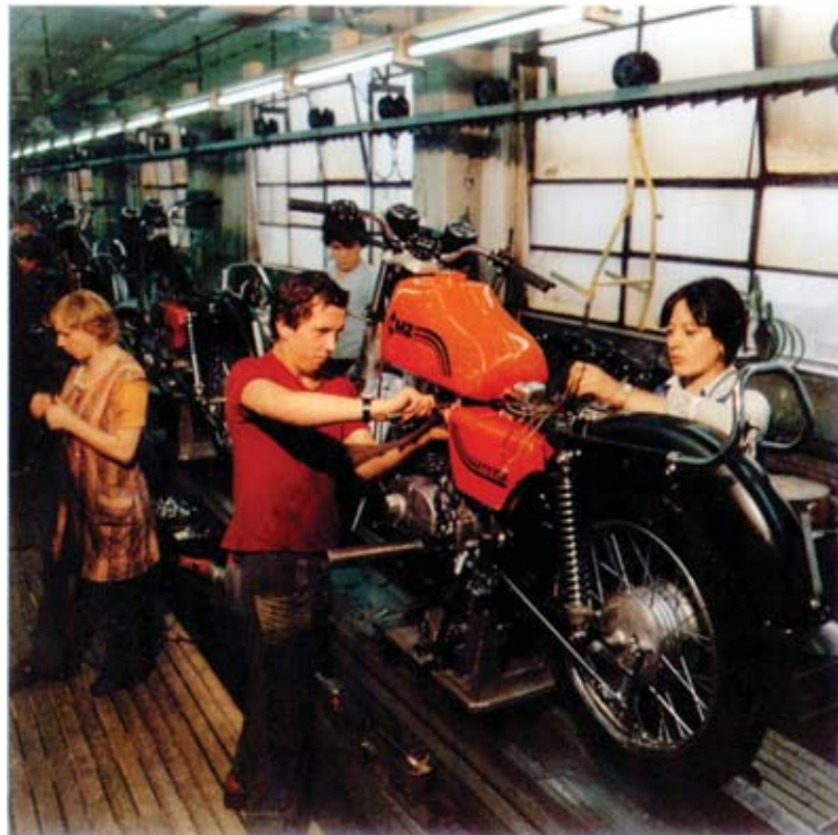
Ohne die Frauen stünden manche Montagebänder still – Arbeiterinnen bei der Elektroinstallation in einem VEB Motorradwerk
