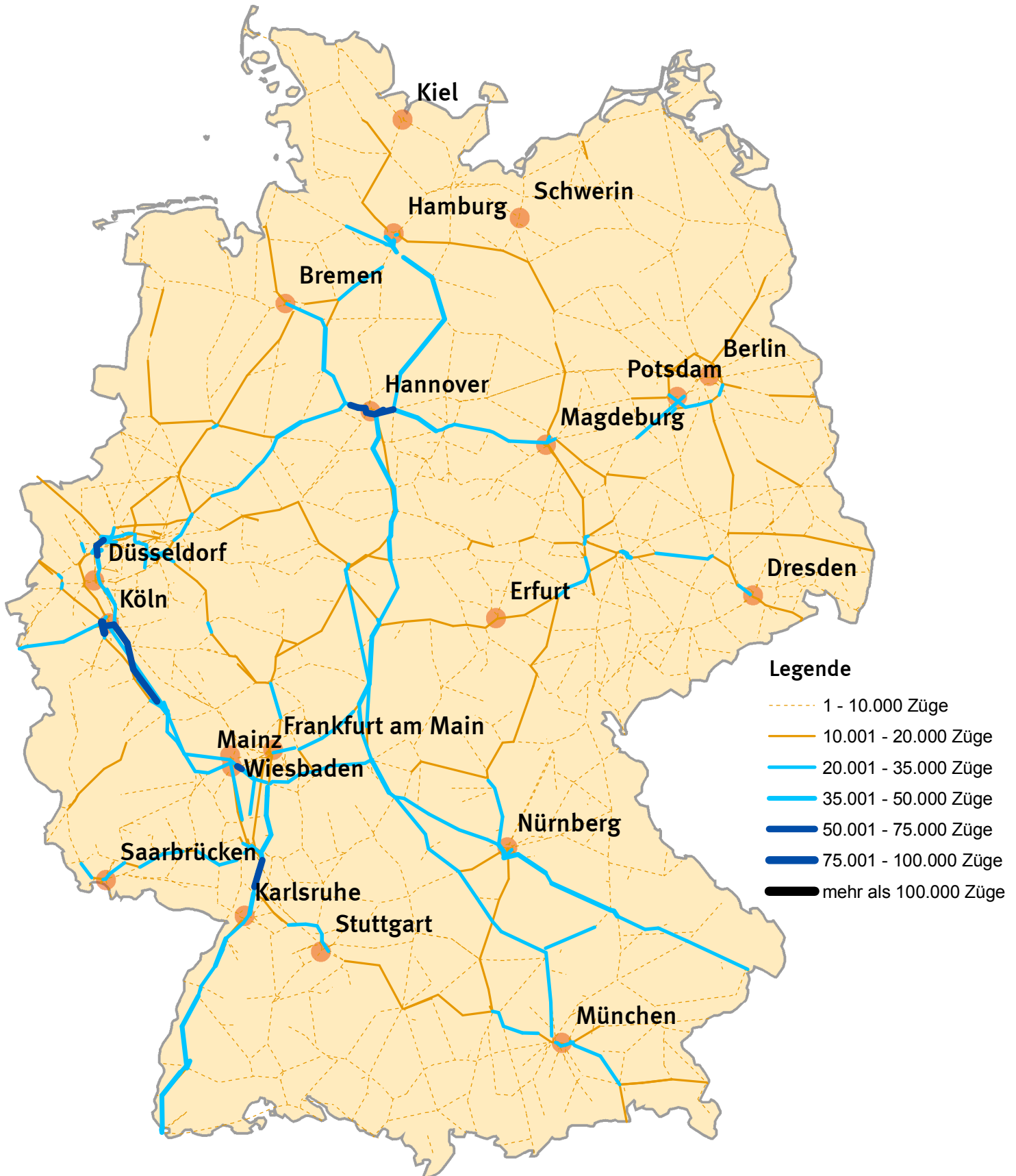
Karte 3: Belastung des Schienennetzes der Eisenbahnen durch Güterzüge 2005
