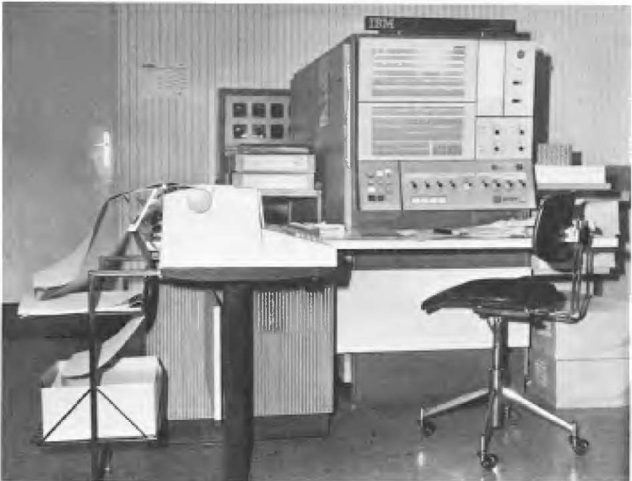
Abb. 4 Zentraleinheit der Rechenanlage IBM 360-30
