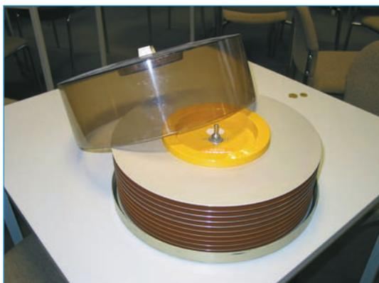
Wechselplattenstapel (ca. 100 MByte) ESER-Technik
