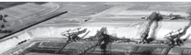
Abraumförderbrücke F60 mit Eimerkettenbagger → Tagebau Jänschwalde in der Niederlausitz
